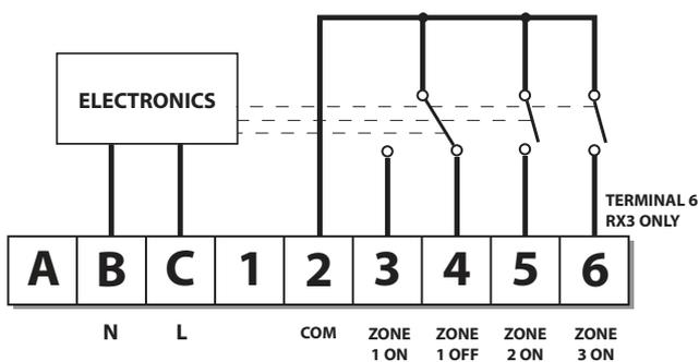
**Importante:** Sui sistemi alimentati con tensione di rete collegare il terminale 2 al circuito di alimentazione di rete
