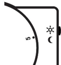
Bei Schalterstellung auf dem Mondsymbol regelt der Thermostat eine Temperatur, die **4°C unter** der auf der Einstellscheibe eingestellten Temperatur liegt.
