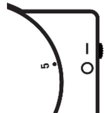
Bei Schalterstellung auf "O" wird die Thermostateistung abgeschaltet und "Off" wird im Display angezeigt.
