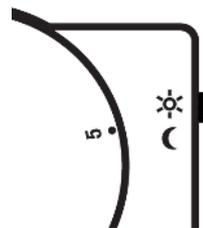
Als de schakelaar op het maantje wordt gezet wordt een nachtverlaging van 4 °C aangehouden.
