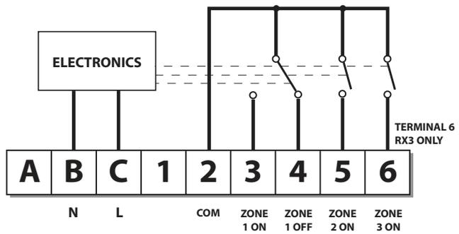
**UWAGA:** Dla systemów zasilanych z głównego systemu zasilania podłączyć złącze 2 do żyły prądowej
