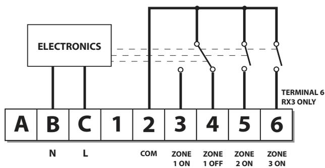
**N.B. Bij netspanning gevoede systemen dient klem 2 te worden aangesloten op de fase van de netvoeding.**
