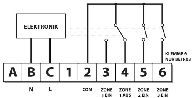
*Hinweis: Bei Systemen, die per Netzspannung betrieben werden, Anschlussklemme (2) an stromführende Leitung (L) anschließen (brücken).*
