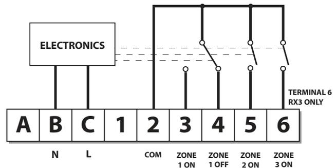
Σημ. Για συστήματα που λειτουργούν με τάση δικτύου, συνδέστε τον ακροδέκτη 2 στον αγωγό φάσεως του δικτύου τροφοδότησης.
