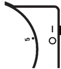
De thermostaat kan worden uitgezet door de schakelaar op "O" te zetten. De thermostaat schakelt dan niet meer in en in het display verschijnt "OF".
