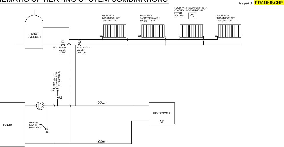
THE ABOVE SHOWS A SCHEMATIC OF A HEATING SYSTEM COMBINING UFH, A DHW CYLINDER & TOWEL RAILS.
