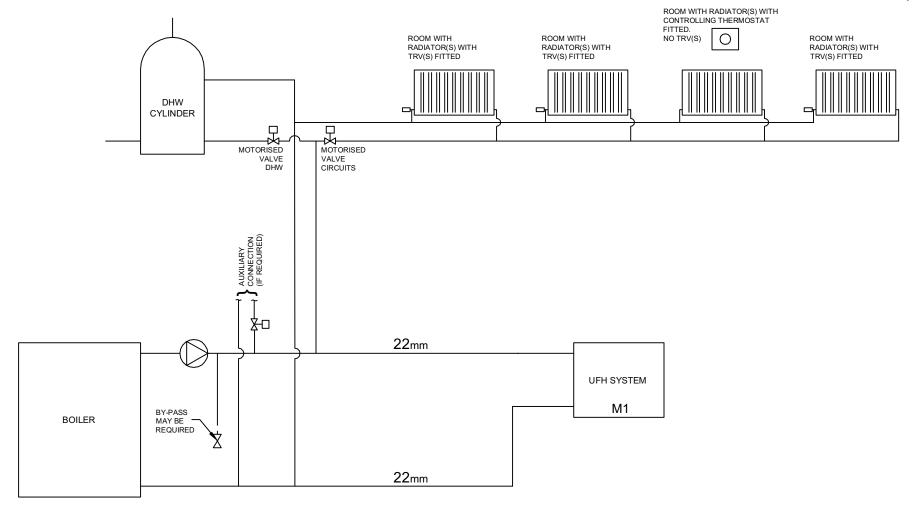
THE ABOVE SHOWS A SCHEMATIC OF A HEATING SYSTEM COMBINING UFH, A DHW CYLINDER & TOWEL RAILS.
